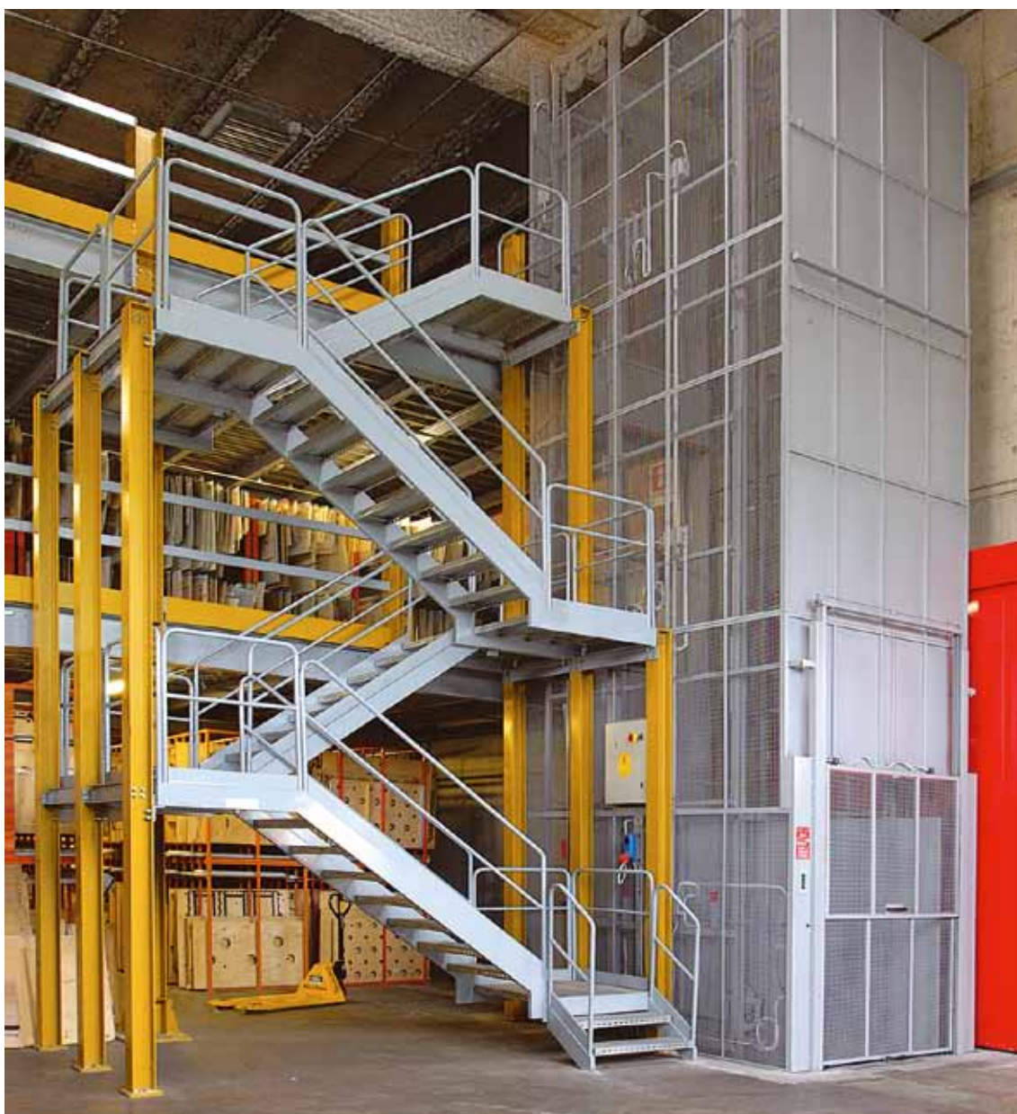
Scale e montacarichi per soppalco a due piani di 1500 m 2
