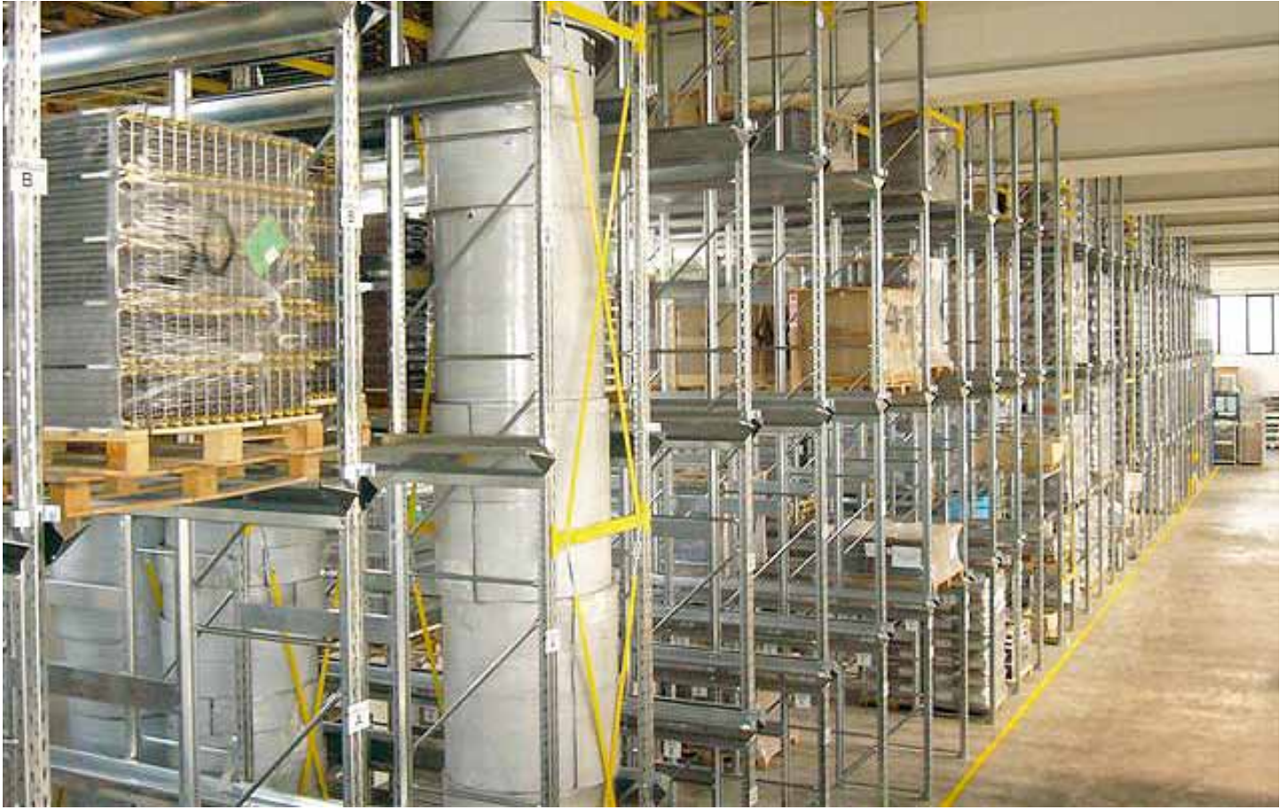
Drive-in componenti condizionatori
