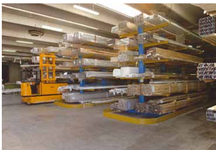
Magazzino Cantilever P per profili, servito da carrello laterale
