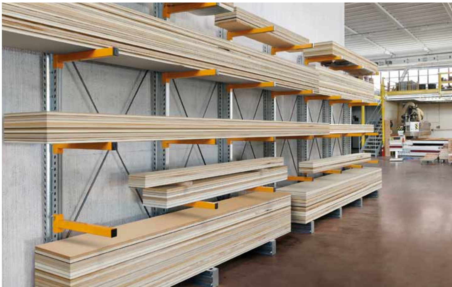
Sistema di stoccaggio pannelli in falegnameria
