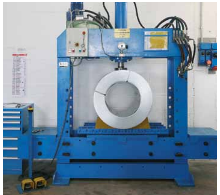
Test di collaudo cunei in laboratorio
