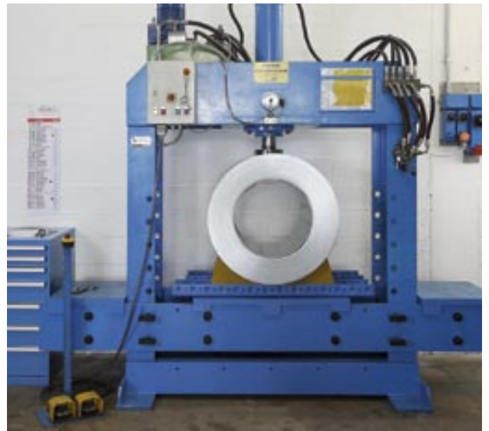
Test di collaudo cunei in laboratorio
